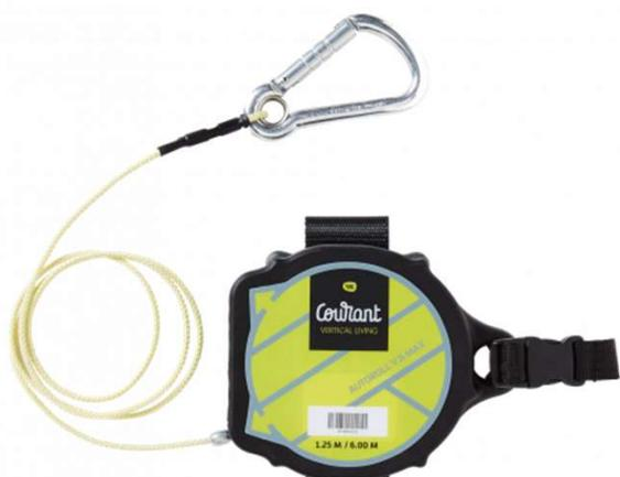
オートロールは隊員同士をリンクしたり、ムーリングカラーやガイドラインに接続することで、進入・検索経路から逸脱することを防ぎます。ラインは1.25mの長さで一度ロックします。進入・検索範囲を広げたい場合にはロックを解除することで、最大6mまで行動範囲を広げることが出来ます。安全帯や呼吸器のベルトに装着して使用することができます。ラインは自動巻取りです。
